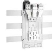
**Adaptateur pour jeu de barres, 1600 A, connexion entre le disjoncteur et l'adaptateur en haut et en bas, par vis**, pour les jeux de barres percés
