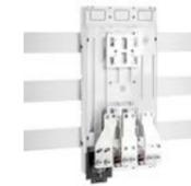
**Adaptateur pour jeu de barres 1600 A, connexion entre le disjoncteur et l'adaptateur en bas, rotation de phase, connexion par vis pour les jeux de barres percés**
