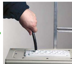
Ziehen Sie das Kabel oder Rohr wieder ca. 20 mm zurück und klemmen Sie es fest.
